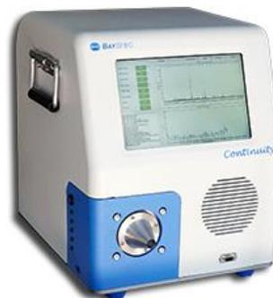
Spectromètre de masse
